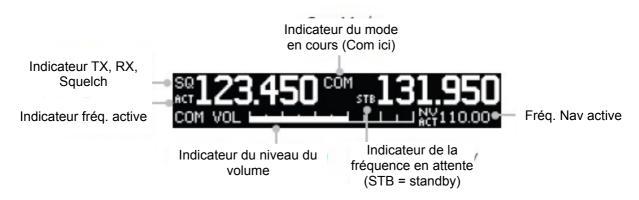
La radio utilise un squelch automatique pour filtrer les bruits indésirables. Vous pouvez forcer cette fonction en pressant le bouton Power/Com Volume/Squelch. Ceci facilite l'écoute d'une lointaine station. L'indicateur SQ apparaîtra sur l'écran. Une autre pression réactive le squelch automatique.
